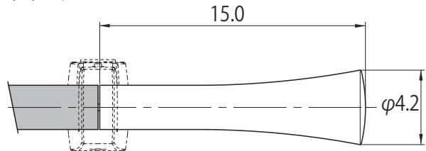
Cキャップの幅は15cmです。取り付け時にはレール幅にキャップ幅が追加されます。取り付け位置の左右は十分なスペースが確保できているか、ご注文前にご確認ください。
