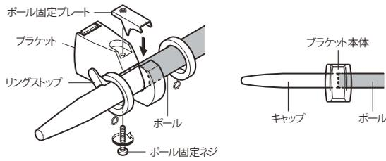
ポールとキャップの継ぎ目をブラケットで隠すことによりポールとキャップに一体感を持たせました。(特許出願中)
