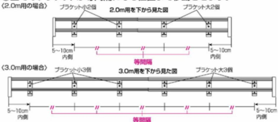
③ブラケットを付属の木ネジで取付位置に⊕ドライバーでしっかり固定します。
