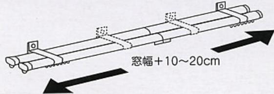
(2)レールの長さに合わせてブラケットの取り付け位置を調節して下さい。両端のブラケットはレールの端から5~10cm位の位置に固定し、残りのブラケットを35~60cmに1個の間隔で固定して下さい。ブラケットには太いレール用にGの刻印、細いレール用にSの刻印があります。またブラケットは等間隔に取り付けるのが理想的です。
