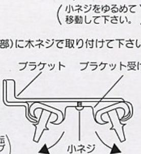
(2)天井付のできるレールの長さは、2m用=1.6~2.0m、3m用=2.6~3.0m、4m用=3.6~4.0m、の間隔です。
