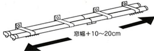
(2)レールの長さに合わせてブラケットの取り付け位置を調節して下さい。両端の
