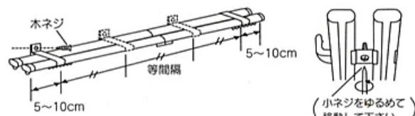
(3)ブラケットをセットした本体を取り付け場所(木部)に木ネジで取り付けて下さい。
