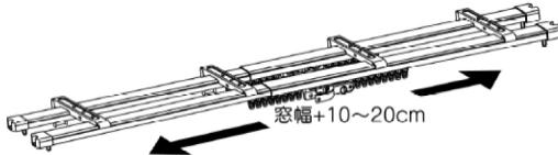
(2)レールの長さに合わせてブラケットの取り付け位置を調節して下さい。両端のブラケットはレールの端から5~10cm位の位置に固定し、残りのブラケットを35~60cmに1個の間隔で固定して下さい。ブラケットにはレールG用に大の刻印、レールS用に小の刻印があります。またブラケットは等間隔に取り付けるのが最適です。
