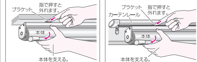
**△注意** 本体をブラケットから外す時は、本体が落しないように支えた手を離さないでください。ブラケットから外している途中で支えた手を離すと落と、破損の原因になります。本体の取付後は、取り外す時以外、ブラケットのプラスチックの突起部分に触れないでください。触れると本体が外れ、落下の原因になります。
